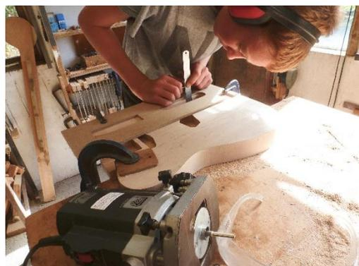
Abb. 12 Vorbereitung für die Arbeit mit der Oberfräse
